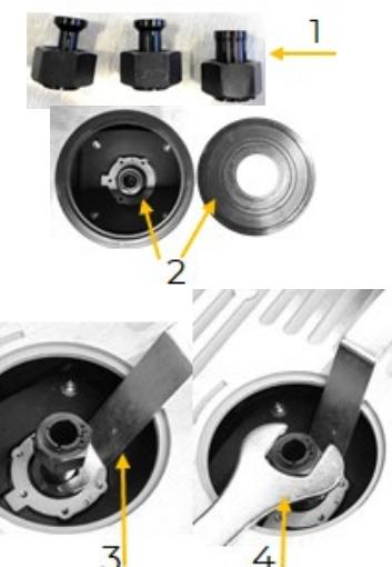
Zvolte upínací sklíčidlo ( $\varnothing$  6 mm,  $\varnothing$  8 mm nebo  $\varnothing$  12 mm), které přesně odpovídá průměru frézy (1).
