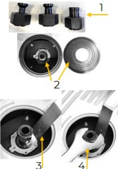
Choisissez la pince de serrage ( $\varnothing$  6 mm,  $\varnothing$  8 mm ou  $\varnothing$  12 mm) qui correspond exactement au diamètre de votre fraise (1).
