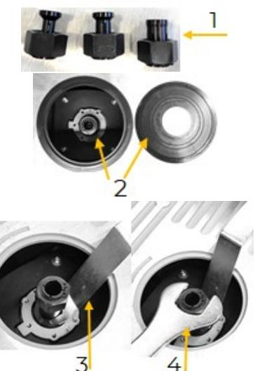
Seleccione el mandril de pinza ( $\varnothing$  6 mm,  $\varnothing$  8 mm o  $\varnothing$  12 mm) que corresponda exactamente al diámetro de su fresa (1).
