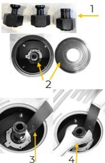
Wählen Sie die Spannzange ( $\varnothing$  6 mm,  $\varnothing$  8 mm oder  $\varnothing$  12 mm) aus, die genau dem Durchmesser Ihres Fräzers entspricht (1).
